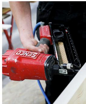
Clous en bande CH, tête D, tige lisse, pointe diamant avec un angle de liaison à 34° et un fil en carbone. Applications bois sur bois, construction en bois, charpente...
