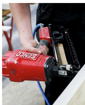
Pack gaz et clous en bande CH, tête D, tige annelés, pointe diamant avec un angle de liaison à 34° et un fil en carbone. Applications bois sur bois, charpente, sous-planchers, palettes et caisses. Livré avec une cartouche de gaz.
