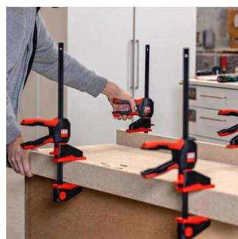
Le mécanisme innovant de rotation à 360° permet de placer la poignée tout autour du rail. Mécanisme de verrouillage à 12 positions pour maintenir en toute sécurité la position de la poignée sélectionnée. Grandes surfaces de serrage avec des protections amovibles. Puissance de serrage jusqu'à 1 400 N. Réversible pour l'écartement, sans outil, grâce à un mécanisme de libération simple par bouton-pression sur la partie supérieure. Commande à une main sans exercer de force.
