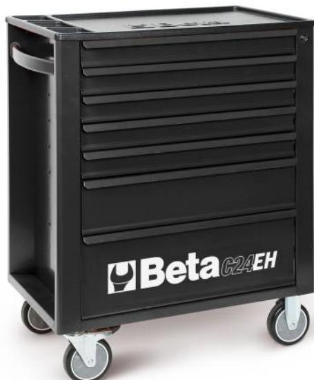
Servante mobile noir avec sept tiroirs de 58,8x36,7cm montés sur glissières à billes de précision. Quatre roues Ø125mm (2 fixes et 2 pivotantes dont une avec frein). Serrure de sécurité centralisée frontale. Plan de travail en ABS. Capacité de charge statique de 700kg.
