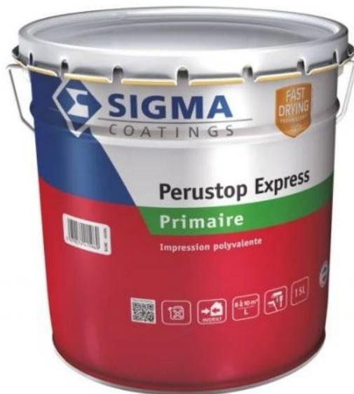
Impression polyvalente à base de résines alkydes uréthannées à séchage rapide. Bloque et uniformise les fonds poreux et absorbants. Application sur matériaux alcalins. Haut pouvoir couvrant. Recouvrable dans la journée.
