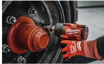
L'acier (Chrome-Mobybdène)SHOCKWAVE™ IMPACT DUTY est un alliage en acier de haute qualité qui fournit une force extrême et une grande durabilité. Meilleure adaptation grâce aux 6 points de fixation. Aucun glissement grâce à sa géométrie hexagonale pour protéger la forme de la douille et de l'écrou. Construction à parois affinées pour un meilleur accès. Marquage du diamètre estampée et rempli d'encre numéro de pièce gravé au laser. Double trou pour les associer avec les accessoires de sécurité.
