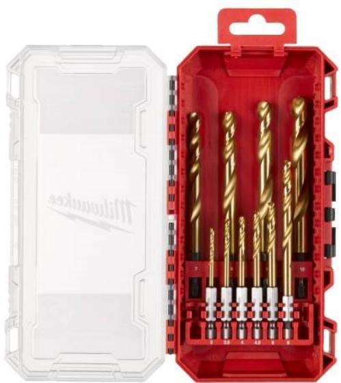
Emmanchement direct 6 pans  $\frac{1}{4}$  hex optimisé pour les visseuses à chocs. Design de la pointe avec blocs d'attaque. Perçage plus rapide et réduction de chaleur, augmentant la durée de vie. Angle de la pointe 135° pour réduire les dérapages. Flûte renforcée (corps plus épais) assure un meilleur transfert de puissance vers la pointe, diminue les vibrations et procure une résistance à la casse exceptionnelle. Design variable de la flûte : 35° - 15° pour une meilleure longévité.
