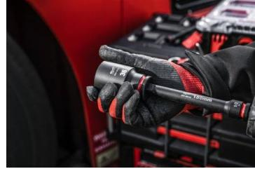
L'acier (Chrome-Mobybdène) Shockwave Impact Duty est un alliage en acier de haute qualité qui fournit une force extrême et une grande durabilité. Meilleure adaptation grâce aux 6 points de fixation. Aucun glissement grâce à sa géométrie hexagonale pour protéger la forme de la douille et de l'écrou. Construction à parois affinées pour un meilleur accès. Marquage du diamètre estampée et rempli d'encre numéro de pièce gravé au laser. Double trou pour les associer avec les accessoires de sécurité.
