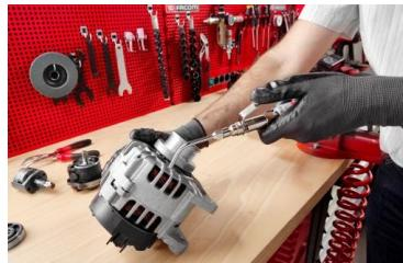
Modèle avec écran d'air pour éviter le retour des poussières vers l'opérateur. Alimentation : filetage 1/4. Diamètre du tuyau : 8 mm.
