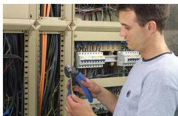
Maintien automatique de la cosse et du câble, avant et après le sertissage. Mâchoire inférieure fixe qui facilite la mise en place de la cosse. Double sertissage avec repérage de la matrice sur l'isolant. Pince ambidextre droitier/gaucher. Matrice inox 3 empreintes :
