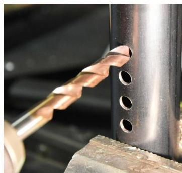
Foret haute performance pour le perçage intensif des aciers inoxydables, aciers résistants et composites grâce à l'affûtage étagé TSP et le revêtement FUSIO. Permet l'agrandissement et des trous nets. Auto-centrage de la pointe. Affûtage SMART POINT. Queue à 3 méplats. Acier rapide.
