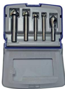
Fraise à noyer haute performance pour les aciers résistants, inoxydables, les fontes les aluminium grâce à son substrat au cobalt et sa géométrie. Angle de fraisage 90°. Queue cylindrique. Acier rapide 5% Cobalt. Tête 3 taillants. Pour les usages généraux dans les métaux jusqu'à 1200 N/mm<sup>2</sup>.
