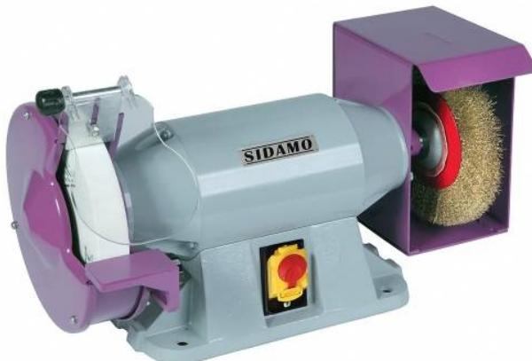
Corps en fonte d'acier. Montage sur roulements à billes étanche auto-lubrifiés. Interrupteur à bobine à manque de tension. Arrêt coup de poing à accrochage. Ecran de protection en polycarbonate. Protection thermique automatique interne au moteur. Carters en acier embouti équipés d'une buse de captage des poussières. Pare-étincelles et porte-outils réglables à 2 mm de la meule.
