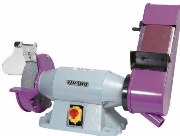
Corps en fonte d'acier. Montage sur roulements à billes étanche auto-lubrifiés. Interrupteur à bobine à manque de tension. Ecran de protection en polycarbonate. Protection thermique automatique interne au moteur. Carter en acier embouti équipés d'une buse de captage des poussières. Pare-étincelles et porte-outils réglables à 2mm de la meule. Carter de bande orientable de 0° à 90° pour travail horizontal ou vertical.
