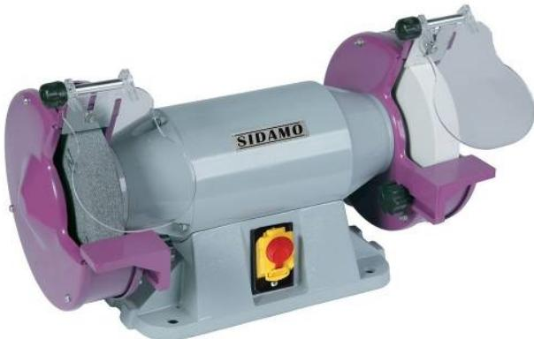
Corps en fonte d'acier. Montage sur roulements à billes étanche auto-lubrifiés. Interrupteur à bobine à manque de tension. Arrêt coup de poing à accrochage. Ecrans de protection en polycarbonate. Protection thermique automatique interne au moteur. Carters en acier embouti équipés d'une buse de captage des poussières. Pare-étincelles et porte-outils réglables à 2 mm de la meule.
