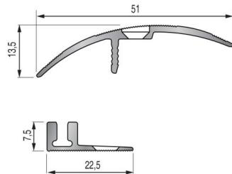
Seuil à visser adapté à une différence de niveaux de 7 à 20 mm entre deux revêtements. Le système DINAP (profil et socle) n'entrave pas la dilatation des parquets et des stratifiés, en transition comme en différence de niveaux. La fixation à visser permet un démontage des profilés lors d'un changement de revêtement.
