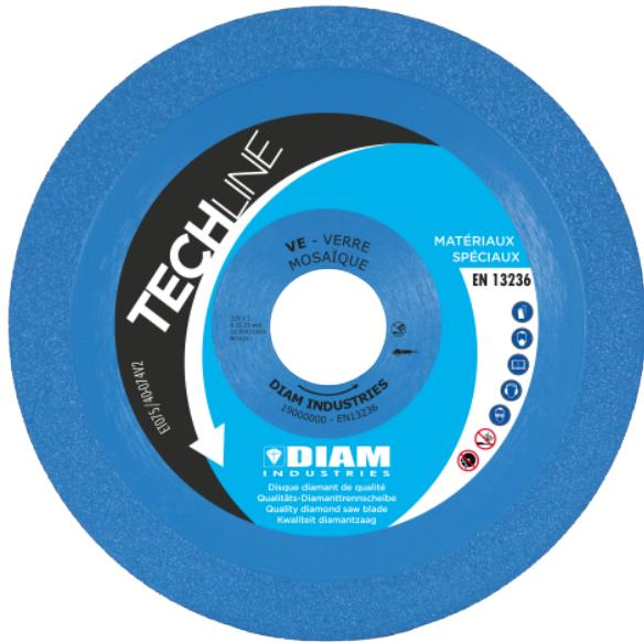
Disque diamant matériaux spéciaux VE pour tronçonnage de verre et mosaïque (pâte de verre). Segment "vacuum brazed" : excellente résistance. Coupe rapide et précise grâce à une épaisseur très fine d'1mm.
