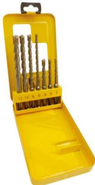
Les forets béton Litor Riss sont des forets béton haute performance, leur design permet une excellent transmission de la force, et ils présentent une durée de vie 9 fois supérieure à celle des forets béton classiques. Traitement trempé à l'air. Brasure à 1100°. Traitement de surface microbillé. Queue SDS+ 3 taillants. Idial pour le perçage sur pierre, granit, parpaing, béton, béton armé, brique, carrelage, marbre ...
