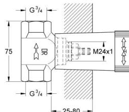
Tête à clapet prémontée en 3/4". Gabarit de protection.
