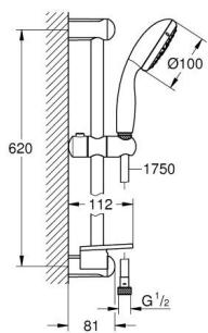
Ensemble de douche Tempesta composé d'une douchette, d'une barre de douche 600 mm, d'un flexible Relexaflex 1750 mm et d'une tablette EasyReach. GROHE DreamSpray débit d'eau uniforme pour tous les types de jets. Finition longue durée. Procédé anti-calcaire SpeedClean. Conduits d'eau internes, longévité maximale. ShockProof anneau en silicone protecteur en cas de chute.
