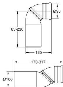
Pipe coudée orientable 90° pour bâti-support WC. Pour réservoir encastré universel ou équipant les bâts-supports avec réservoir universel.
