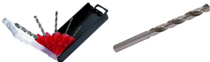
Acier rapide HSS. 61/63 Hrc de dureté. Finition brunissage. Fabriqué par taillage par meulage. Affûtage en croix, auto-centreuret âme renforcée: longévité et + haute performance de perçage. Goujure intégralement meulée après traitement pour une précision optimale. Angle au sommet 135°. Angle d'hélice 30°. Entièrement rectifié. Tolérance sur diamètre : h8.
