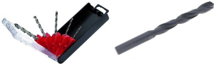
Acier rapide HSS. 61/63 Hrc de dureté. Finition brunissage. Fabriqué par laminage à chaud. Régularité géométrique. Affûtage après traitement pour une précision optimale. Affûtage simple meulage. Angle au sommet 118°. Angle d'hélice 30°. Queue réduite à 13 mm. Marquage du diamètre sur le foret. Tolérance sur diamètre : h8.
