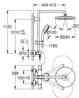
**TurboStat** Régulation de la température quasi-instantanée et sécurité anti-brûlures en cas de coupure d'eau froide.
