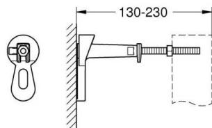
Pour fixation en appui sur mur ou cloison. Réglage en profondeur continu 130 à 230mm.
