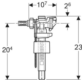
Pour montage dans des réservoirs apparents avec alimentation latérale. Pour les eaux grises (eaux pluviales) au pH 6,0–9,5 en cas d'utilisation d'une installation de filtration. Pour réservoirs en céramique. Pour eau potable. Pour alimentations en eau 3/8".
