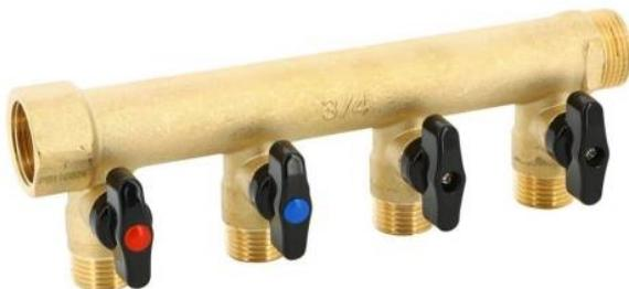
Idéal pour réseau sanitaire, plomberie et chauffage. Collecteur de distribution en laiton composable mâle-femelle, hexagone 6 pans, dérivation M 1/2" à portée plate, équipées de vannes 1/4 de tour. L'étanchéité des vannes est assurée par un presse-étoupe en PTFE et un joint torique en EPDM. Capuchon de couleur démontable pour identification du fluide.
