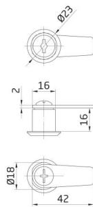
Serrure de boîtes aux lettres en acier avec un ongle droite de 42mm. Inclus 2 clés. Epaisseur maximum 16mm.
