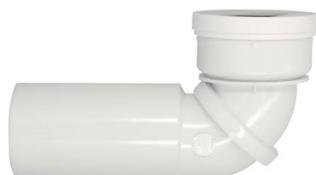
Pipe WC en PVC avec entrée femelle à joint et sortie mâle à coller. Orientable de 0 à 90°. Joint torique EPDM / joint à lèvre en TPE conforme à la norme NF EN 681. Recoupable sur 130mm.
