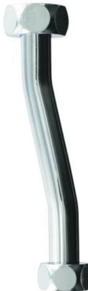
Ce tube chromé pour alimentation apparente, en ligne ou en équerre, permet le raccordement en eau des urinoirs ordinaires de marque: PORCHER modèle urinoir applique 2641, à partir d'une robinetterie temporisée d'entraxe 32mm.
