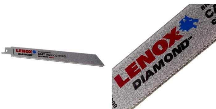
Idéal sur fonte, carrelage, granite et matériaux abrasifs. Coupes droites dans des matériaux difficiles comme les tuyaux grâce à l'acier du dos de la lame en alliage chromé offrant une stabilité accrue. Dure plus longtemps. grâce aux particules de diamant de l'alliage de nickel brasé sur la lame qui préservent le tranchant et prolongent la durée de vie par rapport au grain carbure classique.
