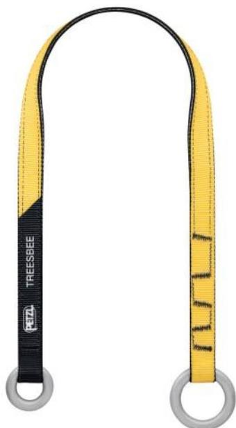
La sangle d'amarrage TREESBEE® permet de favoriser le coulissolement de la corde au niveau de l'amarrage tout en préservant l'arbre des frottements. Elle est destinée aux cordes avec terminaisons épissurées (l'épissure passe dans le petit anneau). Les anneaux en acier zingué assurent une très bonne durabilité.
