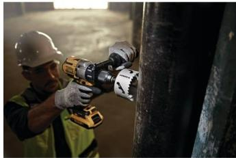
Les scies trépans Speed Slot® au carbure haute performance et au design agressif de la denture permettent de couper aux travers du bois, métal, acier inoxydable, fonte, fibre ciment et plaque de plâtre. Les carbures hautes performances sont soudés sur la lame de coupe pour une plus grande durabilité et éviter la perte de dent. Conception en escalier présentant plusieurs points-levier afin d'éjecter facilement la carotte.
