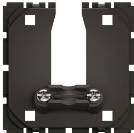
Sortie de câble Céline à compléter d'un support universel Batibox et à combiner avec un enjoliveur et une plaque de finition. Peut être installée en encastré (dans boîte d'encastrement) ou en saillie (sur cadre saillie). Usage en intérieur uniquement. IK04. IP20. Connexion par câble rigide : 2,5mm<sup>2</sup>. Pour câbles : Ø5m à 13mm
