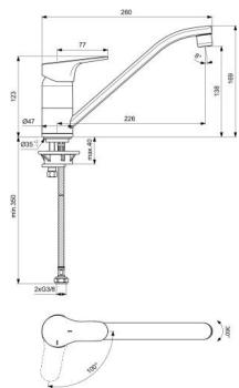
Bec profilé orientable avec aérateur intégré. Ouverture en eau froide en position centrale : Technologie Blue Start. Cartouche Firmaflow® Ø 38mm avec limiteur de température intégré et limiteur de débit 50% déverrouillable. Indicateurs rouge/bleu imprimés sur la manette. Poignée Métal. Système de fixation rapide EasyFix®. Flexibles d'alimentation anti-torsion : PEX 3/8" - 350mm. Hauteur sous aérateur 138mm, hauteur totale 169mm. Projection 226mm.
