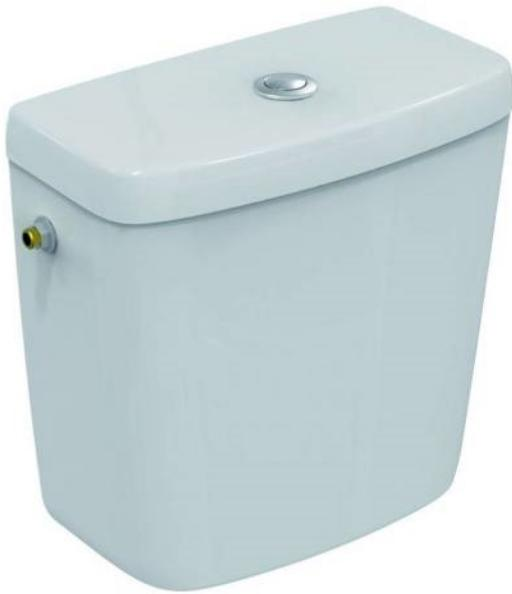
Réservoir Ulysse en porcelaine vitrifiée blanc, à alimentation latérale (sur le côté). Silencieux. Soupape à double chasse 3/6L. Mécanisme SmartValve à remplissage différé. Fixations incluses. Poids : 14,34kg
