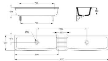
Lavabo Auge contour 21 blanc sans trop-plein. En céramique. Fixation sur consoles de 25cm (réf. D5706AC). À équiper d'une bonde à grille (réf. D5870AA). Hauteur 18cm, profondeur cuve 16cm. Possibilité d'installation en batterie avec couvre-joint(réf. P309001).
