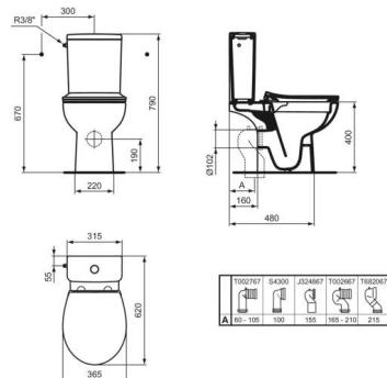
Cuvette à sortie horizontale en porcelaine vitrifiée. Abattant frein de chute thermodur en urea. Fixation par le dessus. Charnières inox. Mécanisme SmartValve pré-installé en 3/6L à remplissage différé. Profondeur 62cm. Poids net : 33,80kg.
