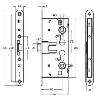
Serrure pour portes coupe feu. Sans fonction anti panique. Avec double carré 9 mm fouillot et double trou de cylindre. Entreaxe: 72 mm. Tête en acier inox. Sans support et sans cylindre. Pour cylindre europrofil avec panneton longue de 15 mm.
