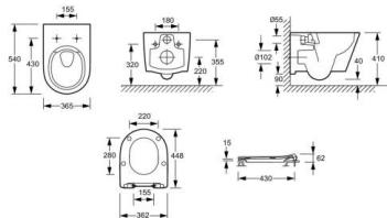
WC en céramique. Abattant thermodur, extra-plat à descente progressive et déclipsable pour faciliter le nettoyage. Charnières en métal. Design contemporain grâce aux courbes simples et épurées. Cuvette entièrement carénée avec fixations invisibles pour une finition parfaite. Hygiène parfaite grâce à la technologie sans bride, qui facilite le nettoyage avec une meilleure performance de chasse. Livré avec fixations.
