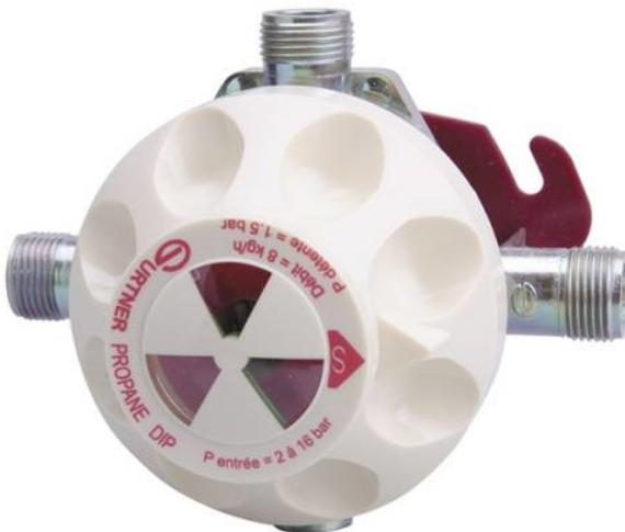
Ce détendeur inverseur assure la continuité de l'alimentation en gaz de l'installation par le passage automatique de la bouteille vide à la bouteille pleine. Cet appareil réalise la première détente de l'installation. Pression amont 16 bar, pression aval 1,5bar.
