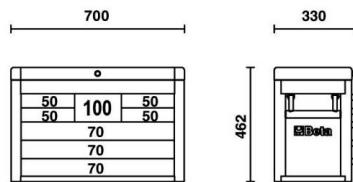
Coffre à outils BETA avec 8 tiroirs (588x277 mm) avec glissières à roulement à billes. Serrure centralisée avant, poignées latérales rétractables pour faciliter la manipulation. 4 tiroirs de 50mm de haut, 3 tiroirs de 70mm de haut, 1 tiroir de 100mm de haut.
