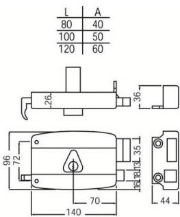
Cylindre laiton Ø 25mm. Variure variée. Cylindre 5 goupilles compatible tout article CISA C2000. Vendu avec 3 clés et gâche.
