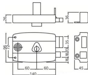
Fouillot carré de 6mm. Cylindre laiton Ø 25mm. Variure variée. Cylindre 5 goupilles compatible tout article CISA C2000.
