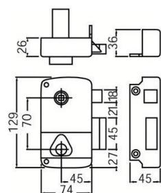
Fouillot carré de 7mm. Cylindre laiton Ø 23mm. Variure variée. Cylindre 5 goupilles compatible tout article CISA C2000. Vendu avec 3 clés et gâche.
