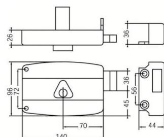
Cylindre laiton Ø 25mm. Variure variée. Cylindre 5 goupilles compatible tout article CISA C2000. Vendu avec 3 clés et gâche.
