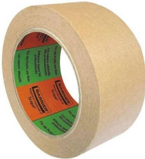
Barnier 9050 est un ruban d'emballage papier, enduit d'un adhésif caoutchouc naturel, d'une épaisseur totale de 120 microns recommandé pour l'emballage et la fermeture de cartons. Composé à 50% de matières biosourcées, le ruban peut être recyclé avec les cartons sans affecter le procédé de recyclage. Ecologique et performant, il permet de remplacer les adhésifs d'emballage plastiques traditionnels.
