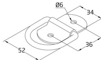
Anneau pivotant en D avec plaque de montage fixe. Acier inoxydable AISI 316. Installation sur plafonds, murs ou poutres en bois. Fabriquée en acier inoxydable qui renforce sa résistance contre la corrosion provoquée par les intempéries. Spécialement conçue pour être installée à l'extérieur.
