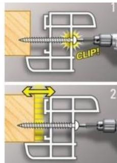
Vis Framex, idéales pour la pose réglable des menuiseries PVC et aluminium en rénovation. Empreinte Torx 25. Tête clips pour pouvoir régler la position et l'alignement du dormant PVC ou aluminium en vissant et dévissant la vis. Vis lubrifiées pour réduire l'effort de vissage. Traitement galvanique chromiting pour une résistance à la corrosion jusqu'à 5 fois plus puissante que le zingué blanc standard.
