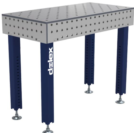
Fabriquée en acier brossé de type S355. Surface brossée. Epaisseur de 12mm et planéité de 0,3mm/m, garantissant une surface de travail précise et plane.
